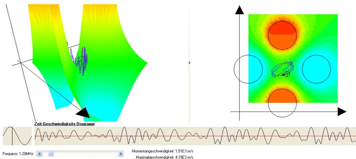
Durch die Endelektroden der linearen Paul-Falle ist die Bewegung des Ions, im Wesentlichen auf diese dargestellte Simulationsebene reduziert.
