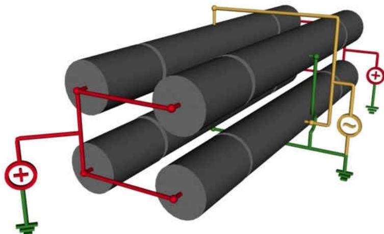
(Elektroden) aufgeteilt: ein Mittelstück und zwei Endstücke. Da die Endstücke gleichnamig zum Ion gepolt sind, also z.B. positiv gepolt sind bei einem positiven Ion, kann das gefangene Ion die Paul-Falle in Längsrichtung nicht verlassen.
